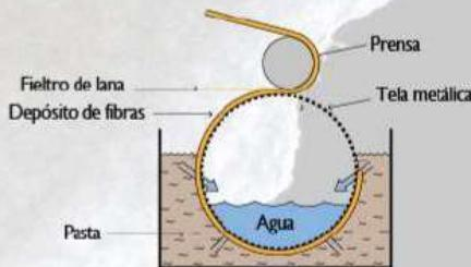
Este método de fabricación ofrece varias ventajas, incluida la más importante que es un buen reparto de las fibras al contrario de la máquina con mesa plana. Los límites de velocidad de fabricación y el ancho estrecho impuestos por esta máquina restringen su uso en la actualidad a la fabricación de papeles de alta gama.
